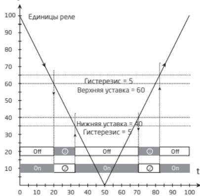
Функция реле: окно (для снижающегося сигнала)
